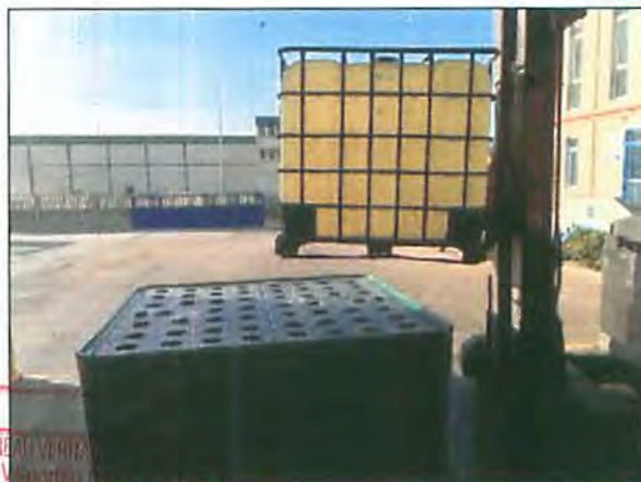
Ejercicio de simulacro, en el que se produce una rotura de la llave del CRO. Colocación del mismo en el cubeto retención
